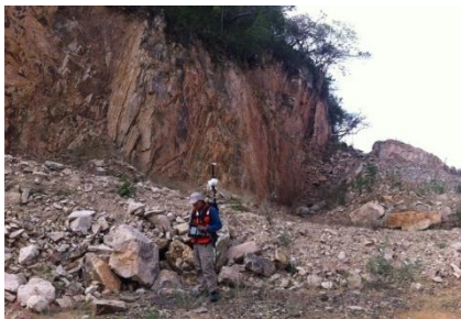
Operación en búsqueda de yacimientos mediante el Magnetómetro Overhauser
